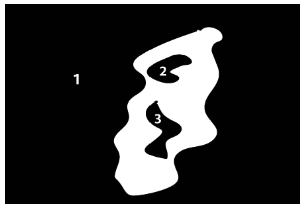
Figur 12.6: Et billede hvor en region growing er anvendt. Det største areal er 1, og betragtes derfor som værende baggrund. De to andre baggrundsvolumener 2 og 3 er huller, som herefter bliver markeret som en arteriedel.
